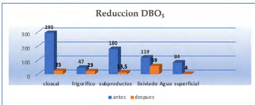
Figura 4: Reducción de la DBO 5 en cada tipo de agua
