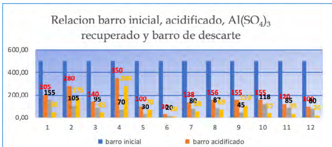
Figura 2: Relación de volúmenes de barros y sulfato de aluminio
