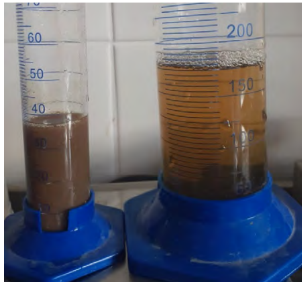
Imagen 1: Separación final del aluminio y el residuo
